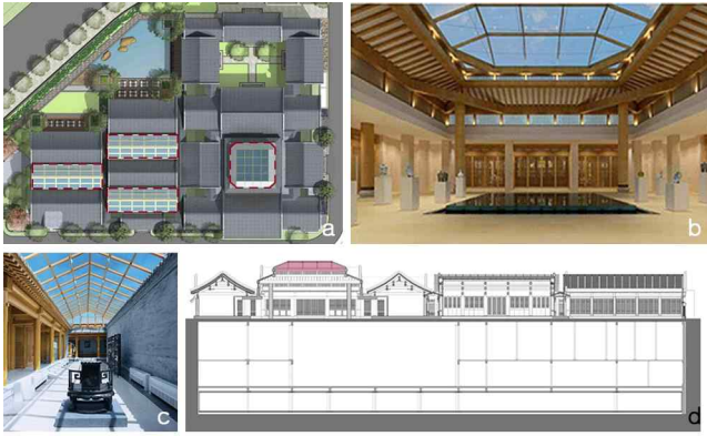
그림 10. 시간박물관의 사진 및 도면 - a.배치도 b.녹정 아트리움 c.박공 아트리움 d.단면도(녹정 아트리움) (출처: 『gooood』, https://www.gooood.cn )
